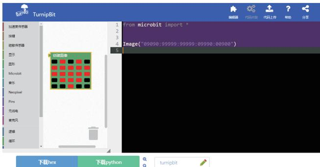
点击左下角的“下载HEX”得到程序，并复制到 TurnipBit 盘符中（黄灯闪烁表示程序复制中）。黄灯熄灭，完成复制，TurnipBit 会自动执行新的程序。
